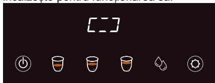
Dispozitivul va verifica automat dacă rezervorul de apă este lipsit de apă, dacă grupul de cafea este în poziție, dacă ușa laterală este închisă etc. Dacă există o problemă, pictograma corespunzătoare a panoului de control va clipe.
