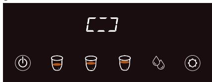
Het apparaat controleert automatisch of het waterreservoir leeg is, of de koffiegroep op zijn plaats staat, of de zijdeur gesloten is, enzovoort. Als er een probleem is, zal het bijbehorende pictogram op het bedieningspaneel knipperen.
