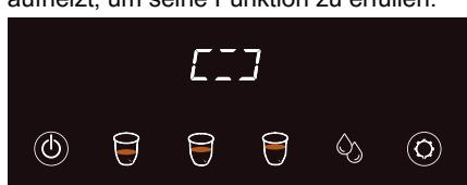
Das Gerät überprüft automatisch, ob der Wassertank leer ist, ob die Kaffeegruppe an ihrem Platz ist, ob die Seitentür geschlossen ist, usw. Wenn es ein Problem gibt, wird das entsprechende Symbol auf dem Bedienfeld blinken. Die Kaffeemaschine wird automatisch Wasser pumpen, um die Kaffeemaschine zu reinigen.
